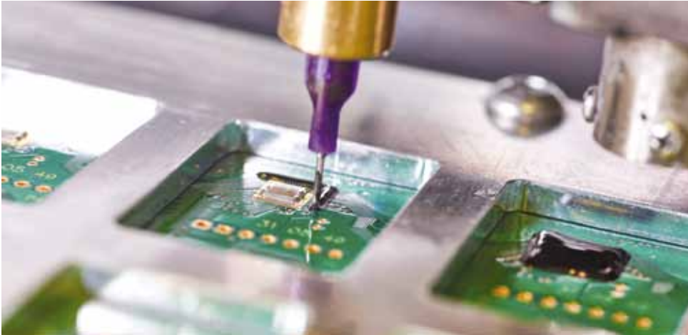
Für seine EMS-Dienstleistungen kann Rafi auf innovative Vergusstechnik zurückgreifen.
